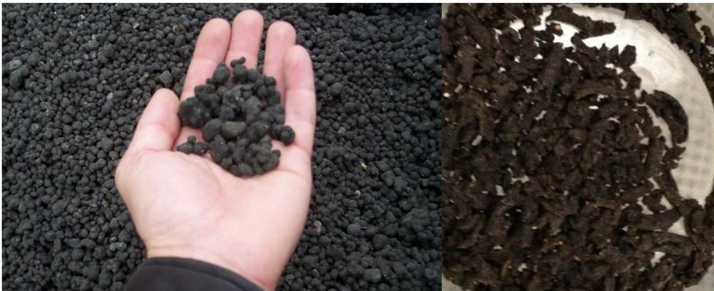
Figure 42 : Aspect des granulés de boues issus de sécheur thermique – photo de droite : granulés de St Marcellin
